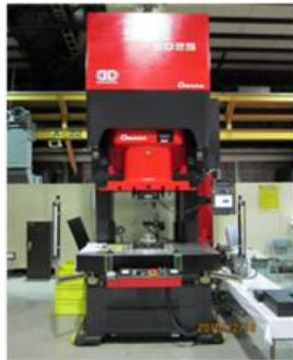
図 1 摩擦試験に使用したサーボプレス
