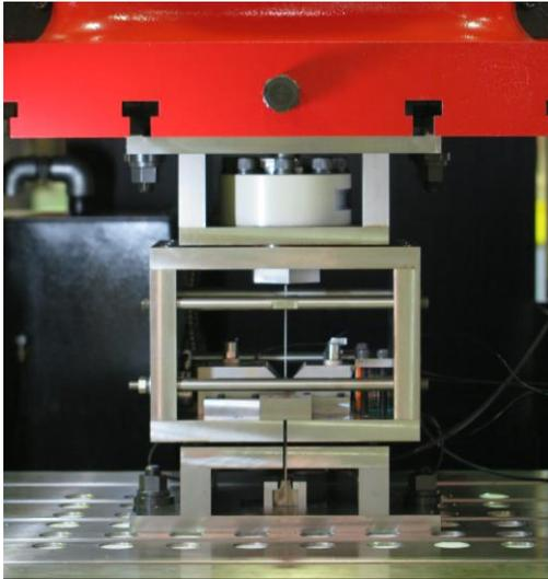
図2 試験前の高速摩擦試験治具
