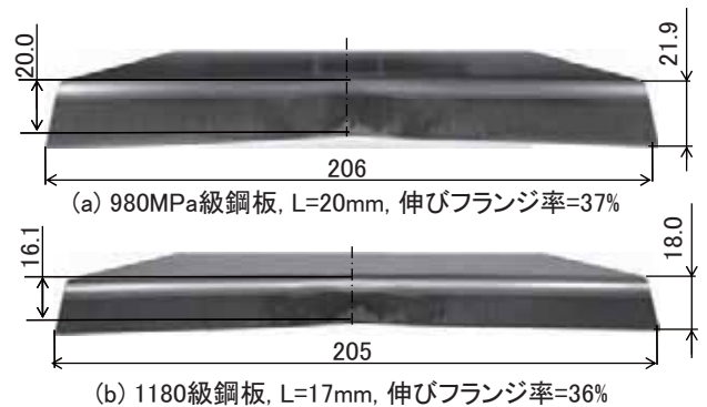
図 16 最適パンチによる限界フランジ長さにおける 980MPa 級鋼と 1180MPa 級鋼成形品
