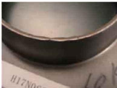
図6 穴広げ成形によるくびれ発生例 (60 キロ鋼)
