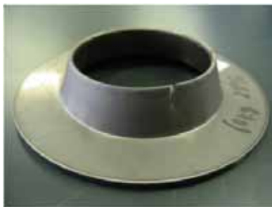
図5 穴広げ成形による割れ発生例 (60 キロ鋼)
