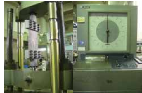
図3 アムスラー型万能試験機
