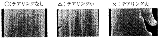
図6 押し形材へのテアリング発生状況
