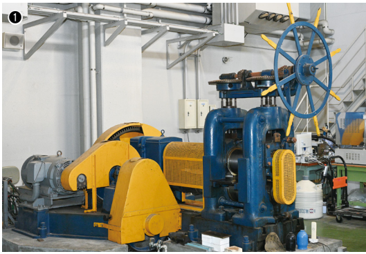
①手回しの圧延機／②Ti-Ni形状記憶合金のミクロ組織の電子顕微鏡画像／③150万倍まで観察できる300kv透過型電子顕微鏡
