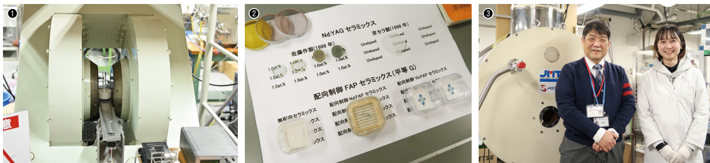
①液相状態の材料に強い磁場を加えることで、異方性結晶の結晶軸を同一方向に制御する／②佐藤博士らがこれまでに作成したNd:YAGセラミックスと配向制御FAPセラミックスのサンプルなど／③佐藤博士(左)と技術支援員の松田美帆さん(右)
