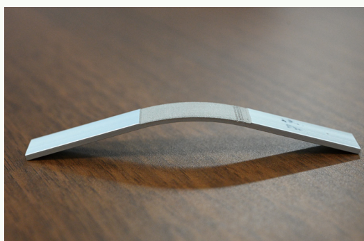
小型集積レーザーを使ってレーザーフォーミングで曲げ成形したアルミ部品
