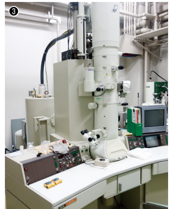
①手回しの圧延機／②Ti-Ni形状記憶合金のミクロ組織の電子顕微鏡画像／③150万倍まで観察できる300kv透過型電子顕微鏡
