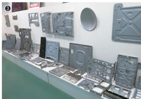
①治具から周辺装置まで含めた独自の改造を加えることで、加工機と一体になった加工技術を開発している／②耐圧限界試験を行った6-4チタン製やTP270製のタンク／③±0.05mmの精度が求められるOA機器部品の加工サンプル
