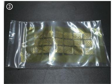
①パルスレーザー、ガルバノミラーなどを組み合わせた独自のレーザー加工系／②パルスレーザーを使い作製されたTHz光学素子／③独自に作成したTHz帯撮像素子
