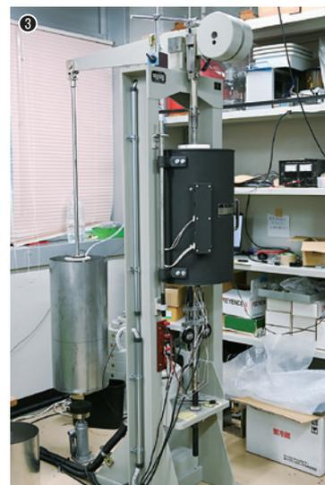
①熱間塑性加工により作製した不均一組織を有するLPSO型Mg合金の表面観察像／②Mg合金のクリープ特性を調べるためのクリープ試験機制御装置／③約1300℃までのクリープ試験が可能な高温クリープ装置
