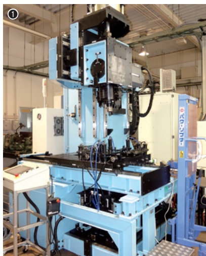
①大阪産業技術研究所が保有する摩擦攪拌接合装置／②摩擦攪拌を行う回転ツール／③摩擦攪拌によって作製された水素吸蔵合金(中央)
