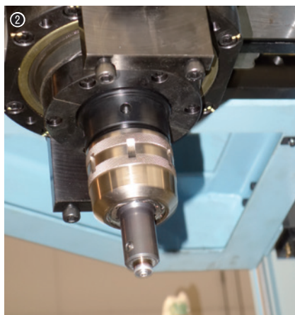
①大阪産業技術研究所が保有する摩擦攪拌接合装置／②摩擦攪拌を行う回転ツール／③摩擦攪拌によって作製された水素吸蔵合金(中央)
