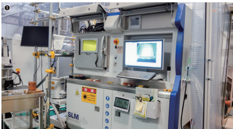
① SLMソリューションズの3D金属積層造形システム／②ガルバノミラーを使ってレーザービームを自由に動かし、金属粉末を積層造形する／③積層造形で製作した各種サンプル
