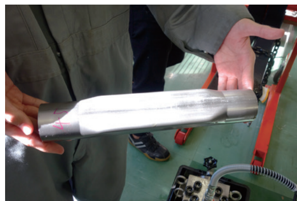
成形後の鋼管(チューブ)
