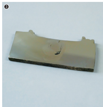
①大阪産業技術研究所が保有する摩擦攪拌接合装置／②摩擦攪拌を行う回転ツール／③摩擦攪拌によって作製された水素吸蔵合金(中央)
