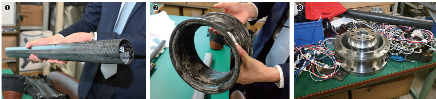
①熱可塑性CFRPテープを用いて、組みひもと呼ばれる手法とプレス成形を組み合わせで高強度チューブを成形／②組みひもとプレスを応用して成形したホイールリム／③ホイールリムの成形に用いた金型の一部
