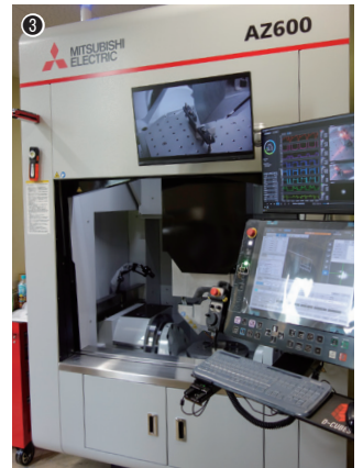
①半導体レーザー加工装置によるニッケル材への溶接実験／②肉盛り溶接されたニッケル材／③材料に金属ワイヤ、熱源にレーザーの組み合わせを採用した「ワイヤ・レーザー金属3Dプリンタ」
