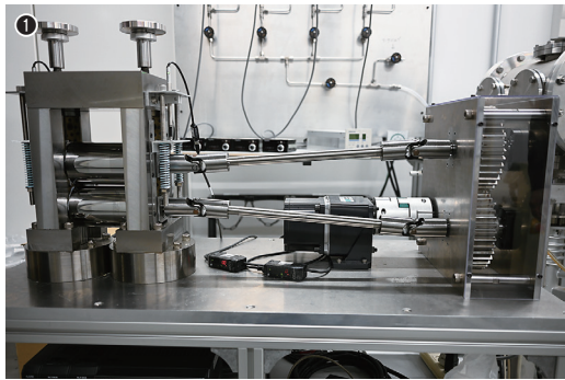
①天田財団の2019年度「一般研究開発助成」に採択された研究の際に製作された実験用圧延機／②印刷物を工具に用いたほかの凹凸転写方式／③印刷工具の凹凸をアルミニウム円板に転写したQRコード
