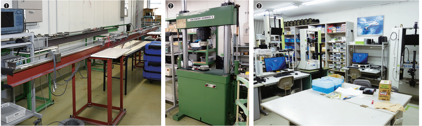
①Taylor衝撃実験装置／②引張・圧縮・曲げ試験を1台で行うことができる油圧万能試験機／③引張試験装置などが並ぶ共有の実験設備
