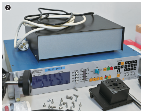
①レーザー光源や駆動装置などで構成された実験装置／②ステッピングモータコントローラなどの測定装置／③移動してきて1年目の実験室の整備はこれから
