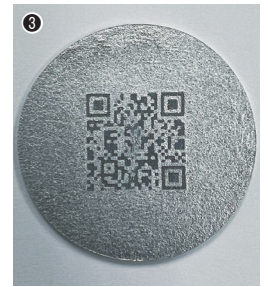
①天田財団の2019年度「一般研究開発助成」に採択された研究の際に製作された実験用圧延機／②印刷物を工具に用いたほかの凹凸転写方式／③印刷工具の凹凸をアルミニウム円板に転写したQRコード
