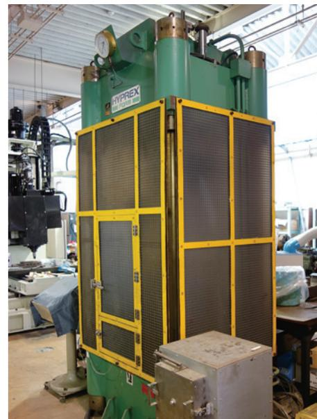
マグネシウムなどの軽金属の押し出し加工を行う装置
