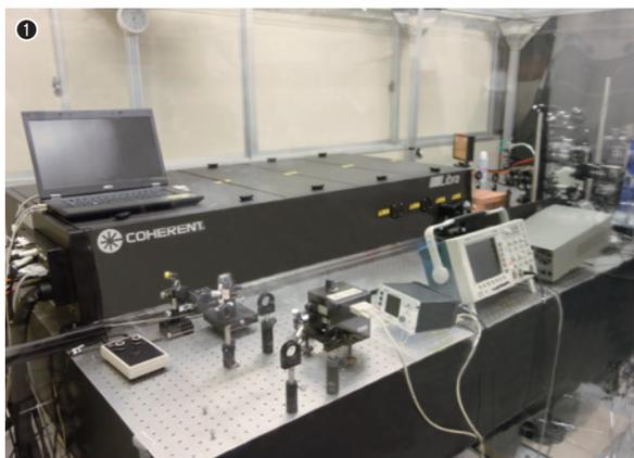
①研究室に設置されている全固体ワンボックス型フェムト秒再生増幅器
