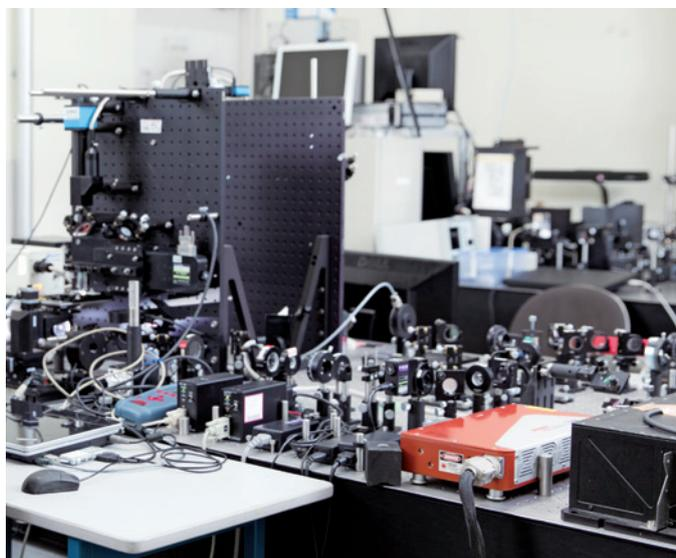
フェムト秒レーザー3次元加工装置
