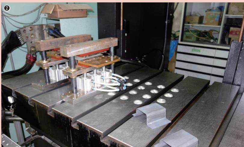
①油圧式万能試験機による引っ張り試験で強度評価を行う／②水冷式のスマートホットスタンピングの加工実験。サーボプレスにセットされた金型と加工された部材
