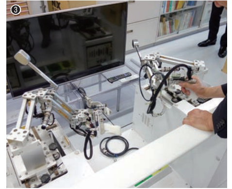
①低侵襲手術支援ロボットの遠隔操作ユニット。実際にこの支援ロボットとユニットを使った遠隔手術実験が行われた／②低侵襲手術支援ロボット／③低侵襲腹腔鏡下手術支援ロボットは鉗子用2本、腹腔鏡用1本の計3本のアームがあり、執刀医は腹腔鏡の映像を見ながら操作する
