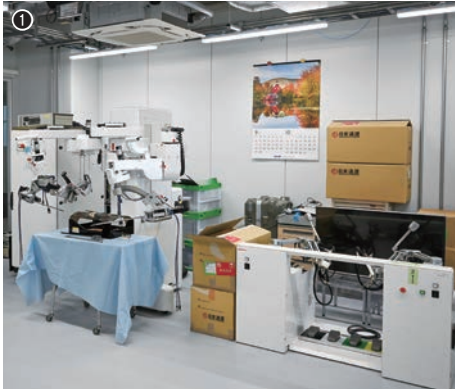
①低侵襲手術支援ロボットの遠隔操作ユニット。実際にこの支援ロボットとユニットを使った遠隔手術実験が行われた／②低侵襲手術支援ロボット／③低侵襲腹腔鏡下手術支援ロボットは鉗子用2本、腹腔鏡用1本の計3本のアームがあり、執刀医は腹腔鏡の映像を見ながら操作する
