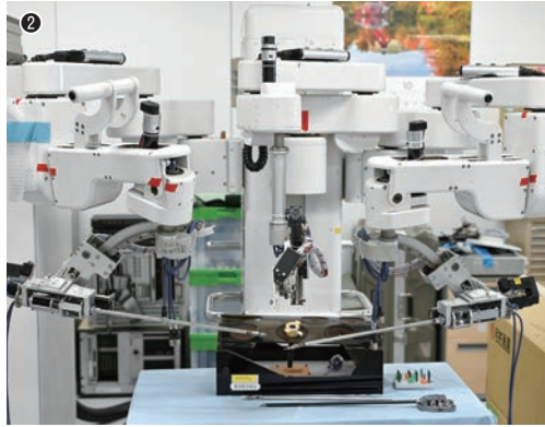
①低侵襲手術支援ロボットの遠隔操作ユニット。実際にこの支援ロボットとユニットを使った遠隔手術実験が行われた／②低侵襲手術支援ロボット／③低侵襲腹腔鏡下手術支援ロボットは鉗子用2本、腹腔鏡用1本の計3本のアームがあり、執刀医は腹腔鏡の映像を見ながら操作する
