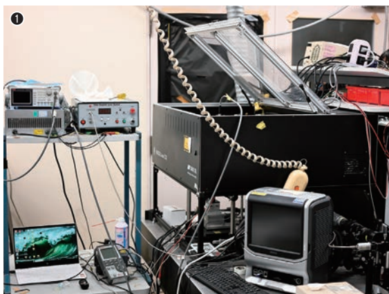
①金属イオン含有ガラスにCWレーザーを照射するCO 2 レーザー装置／②シリカとホウ酸の成分を含んだガラスにCWレーザーを照射し、ガラス基板の内部まで加熱する／③CWレーザーによって溝が加工された「遷移金属イオン含有ガラス」
