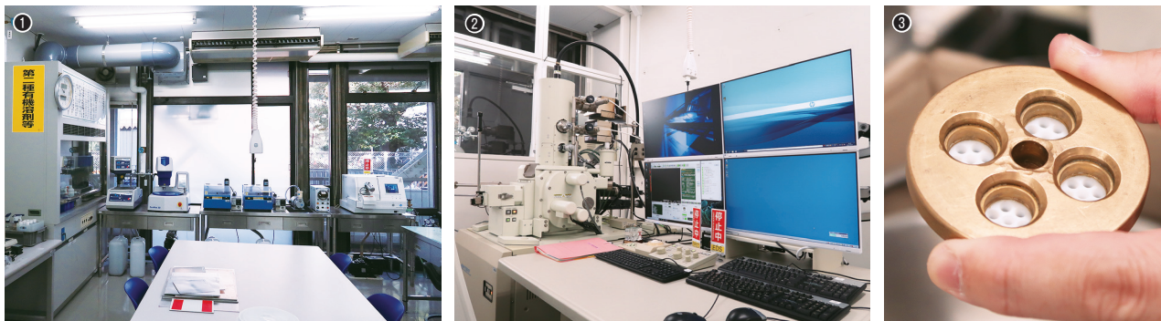
①実験室。2024年秋には理工学部エリアの新棟建設が終わるため、新たな実験室に移動する／②電界放出形走査型電子顕微鏡装置。4つの画面で元素分析、結晶方位の様子などが確認できる／③塑性加工や金型の知識を活用し、パスタ押しマシンのダイス設計なども行っている
