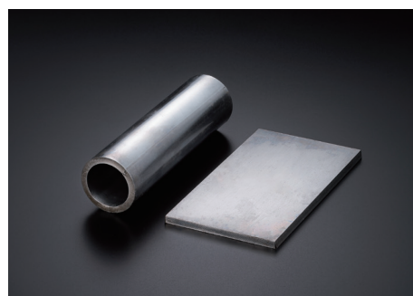
日本塑性加工学会会長賞を受賞した(有)原プレスエンジニアリング(神奈川県)の「厚板の丸め成形品」(W90×D26×H26mm)
