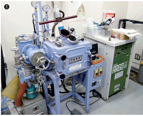
①真空アーク溶解装置／②650℃までの相変態や比熱を測定する／③薄膜試料の作製ができるイオンミリング装置
