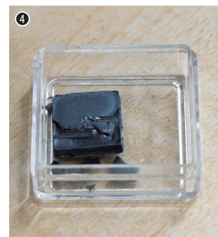
①今回の研究に使用する表面加熱・表面検出レーザーフラッシュ法（FF法）の装置の概略図／②実際に作製中のFF法の実験装置／③パルスレーザーを照射する装置をはじめとしたFF法実験装置の中核部分／④FF法に使用する試料
