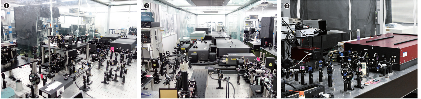
①レーザー光源と自作したレーザー加工装置や光学効果評価システム／②パルスレーザー加工システム／③赤外フェムト秒レーザー加工装置
