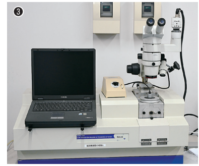
①真空アーク溶解装置／②650℃までの相変態や比熱を測定する／③薄膜試料の作製ができるイオンミリング装置
