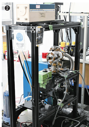
①今回の研究に使用する表面加熱・表面検出レーザーフラッシュ法（FF法）の装置の概略図／②実際に作製中のFF法の実験装置／③パルスレーザーを照射する装置をはじめとしたFF法実験装置の中核部分／④FF法に使用する試料
