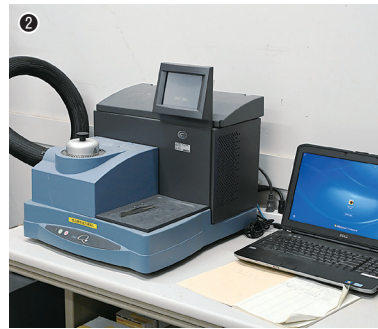
①真空アーク溶解装置／②650℃までの相変態や比熱を測定する／③薄膜試料の作製ができるイオンミリング装置
