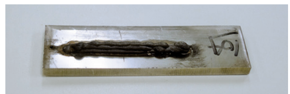
ホットワイヤ方式で3D造形された製品サンプル
