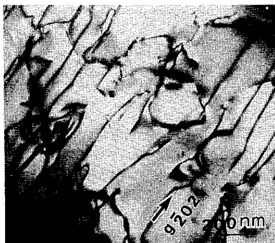
図3 1523Kの温度で変形された \text{Cr}_{67.8}\text{Nb}_{32.2} 合金内の変形転位組織像
