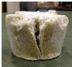
図8 圧縮試験によるガラス繊維強化氷の破壊の様子 ( C_w = 30 \text{ wt.}\% )
