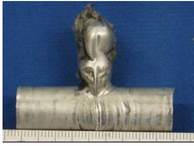
図1 2 枝管成形例（紙パルプ繊維 C_w = 30 \text{ wt.}\% ，金型及び試験片の予冷温度 -5^\circ\text{C} ，スライド速度 60\text{m}^{-1} (クランクモーション，ストローク長さ 225\text{mm} )
