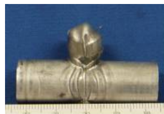
図11 枝管成形例(紙パルプ繊維 C_w = 8 \text{ wt.}\% , 金型及び試験片の予冷温度 -30^\circ\text{C} , スライド速度 60\text{m}^{-1} (クランクモーション, ストローク長さ 225\text{mm} )
