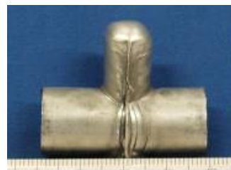
図10 枝管成形例(紙パルプ繊維 C_w = 30 \text{ wt.}\% , 金型及び試験片の予冷温度 -30^\circ\text{C} , スライド速度 60\text{m}^{-1} (クランクモーション, ストローク長さ 225\text{mm} )
