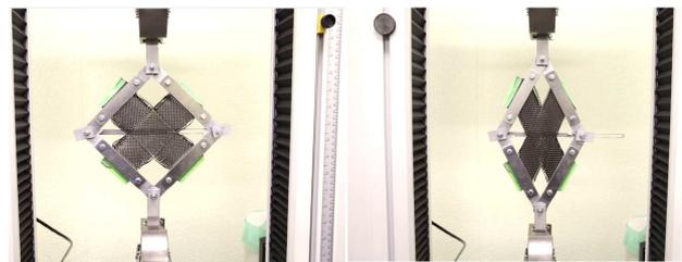
図6 ピクチャーフレーム試験
