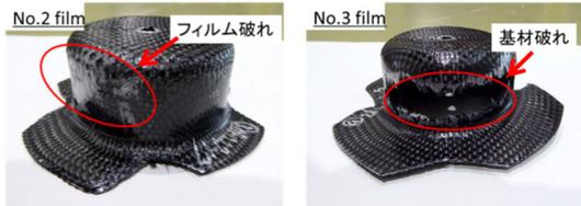
図5 プレス成形品の外観(成形ストローク:30mm)
