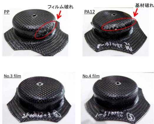
図 3 プレス成形品の外観(成形ストローク:20mm)
