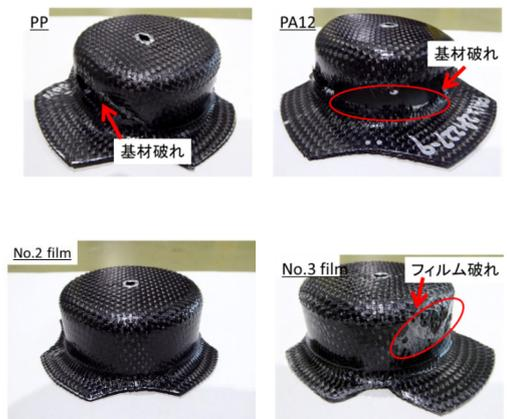
図 4 プレス成形品の外観(成形ストローク:25mm)
