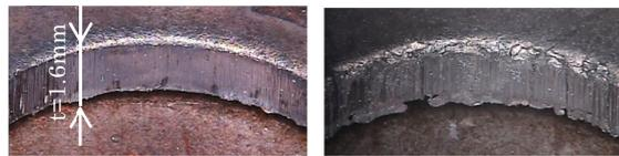
(a) 工具3により得られた初回切口面 (b) 工具3で2000回目に得られた切口面
