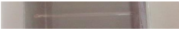
図6 焦点位置 (原点), 走査速度 3 mm/sec における薄板溶着表面 (PET)
