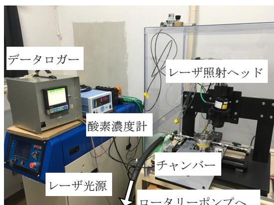
図3 レーザブレイジング雰囲気の酸素濃度測定システムの外観
