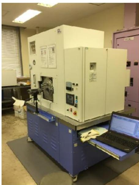
図 1 : パルス通電加圧焼結装置.
