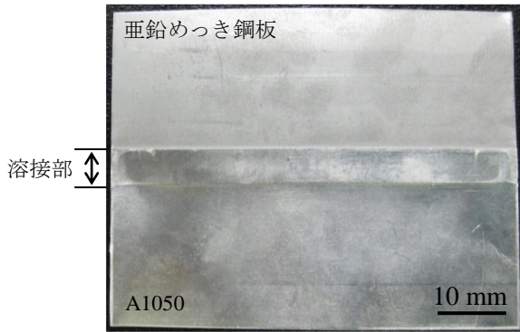
図2 溶接継手の外観写真
