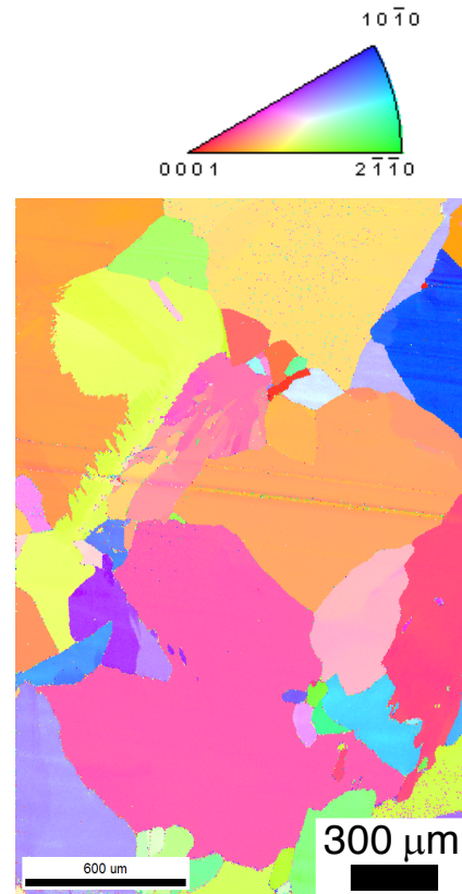
図6 高温圧縮試験に用いた Ti 3 Al 焼結体の初期組織
