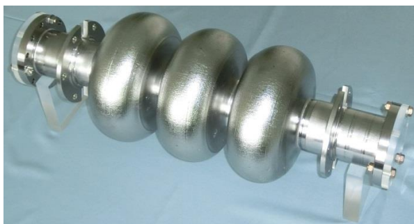
図 13 液圧成形により製作した 3セル空洞
