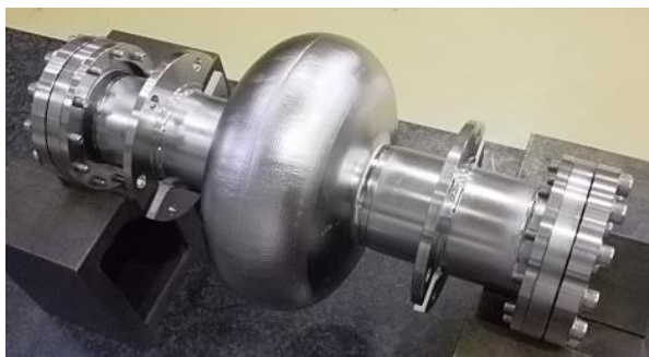
図7 完成した1セル空洞
