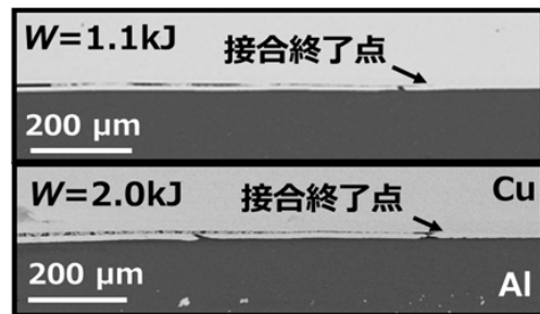
図9 W の増加による接合終了点の組織変化
