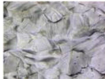
図 2 塑性変形 17%時の表面性状
