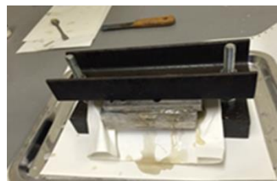
(e) 金型をプレスし硬化させる
