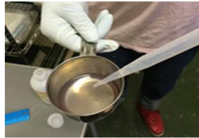
(b) 樹脂に硬化剤を添加する
