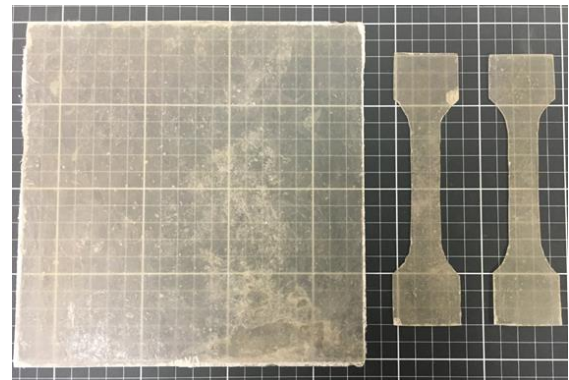
図8 FRP材料の力学特性を測定する引張試験片
