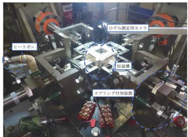
図1 温間二軸引張試験装置
