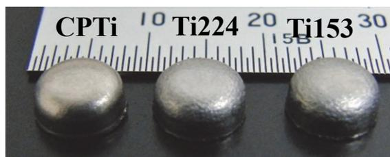
図9 チタンおよびβ型チタン合金の絞り加工後の形状
