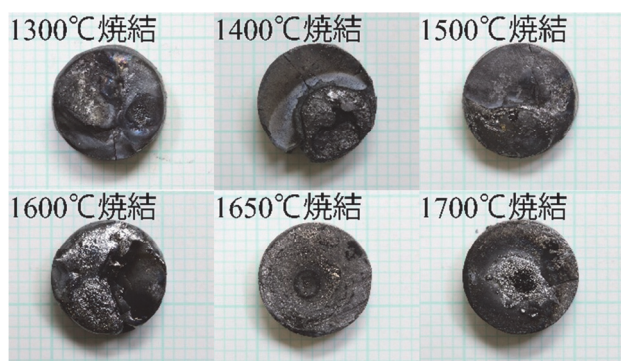
図7 B+CF原料粉末を用いて作製した焼結サンプルの アーク放電耐性の評価結果
