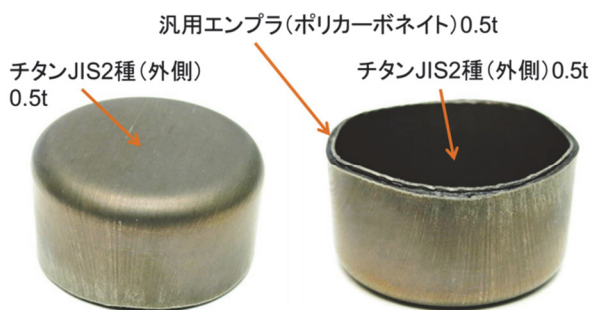
図12 3層積層板のクラッド容器 (総板厚 1.5mm の積層板)
