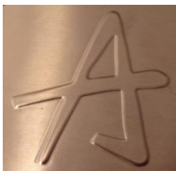
図7 爆薬を用いた実験結果(銅板厚さ 0.3mm)
