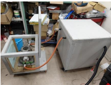
図3 液中放電成形法に使用する衝撃波発生装置(左側が耐爆容器、右側が衝撃波発生装置)
