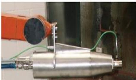
図1 コールドスプレー装置ガンヘッド<sup>7)</sup>
