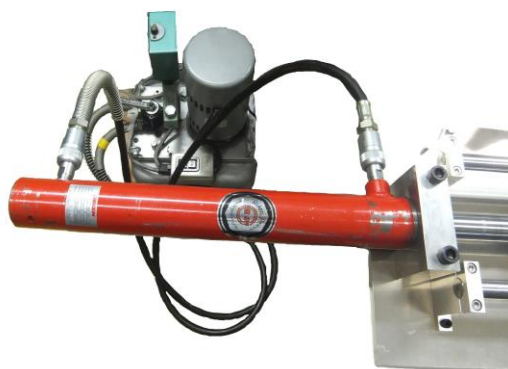
Fig. 7 伸線に用いた油圧シリンダー
