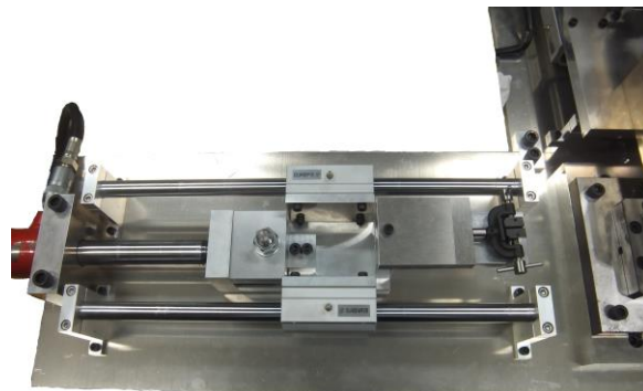
Fig. 8 チャック用稼働台のリニアブッシュ
