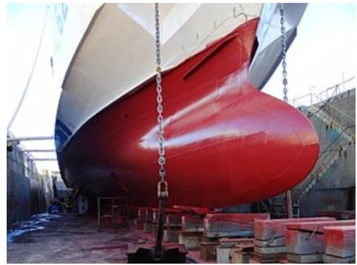
図 1 船体の自由曲面外板
