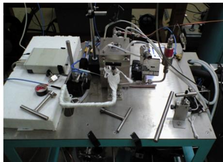
図2 超臨界二酸化炭素発生装置
