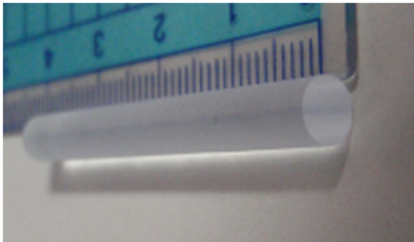
図7 ロッド形状加工品 (4.8mmφ, プレーナ部分厚み0.5mm)
