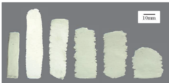
図2 繰り返し圧延された試験片( D=40\text{mm} , V=0.05\text{m/min} )
