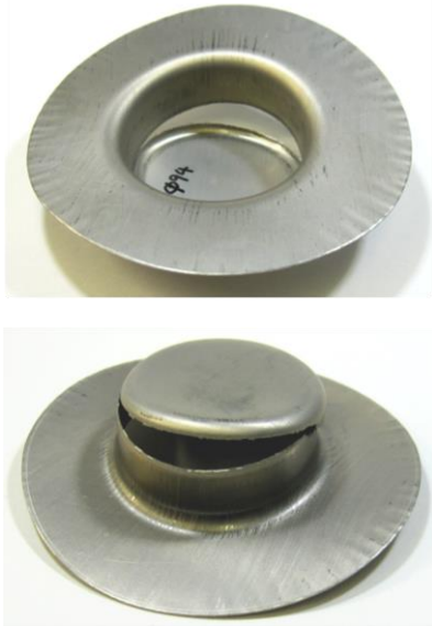
図5 ブランク直径94mmにおける 深絞り加工中に破断した容器外観
