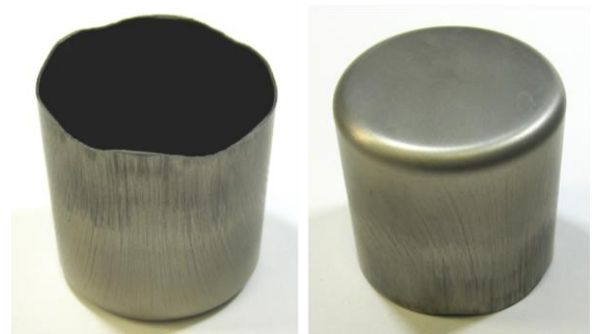
図 4 ブランク直径 92mm における深絞り成形した容器外観
