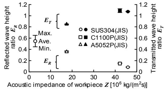
図5 試験片の音響インピーダンスと反射および透過波高比の関係
