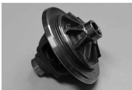
図2 溶接されたディファレンシャルギヤ試料
