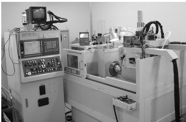
図6 金型加工に用いた超精密加工機 （東芝機械製 ULG-100D (SH 3 )）
