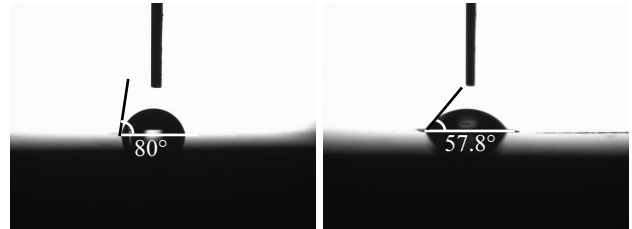
(a) 平面 (b) 微細構造表面 図13 金属蒸着膜表面の水滴形状
