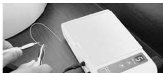
(c) パルス通電による NiTi 超弾性矯正ワイヤの形状修正<sup>4)</sup>
