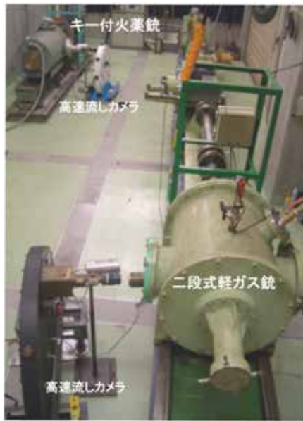
図2 熊本大学の衝撃超高压実験室 (一段式火薬銃、二段式軽ガス銃と組み合わせた高速流しカメラユゴニオ計測システム)
