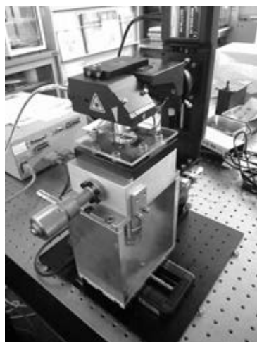
図4 レーザー融着装置と被加工材固定治具の外観。
