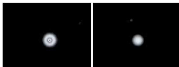
図 11 ピンホール#0 と#3 の後ろでのビームプロファイル。波長 532nm。
